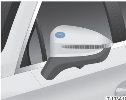
Wenn das Fahrzeug ausgeschaltet ist und die NFC-Schlüsselkarte an das "NFC"-Symbol auf dem linken Außenspiegel gehalten wird, werden alle Türen gleichzeitig entriegelt, die Blinkerleuchten blinken zwei Mal auf, und die Außenspiegel werden ausgeklappt (wenn diese Funktion aktiviert ist).
