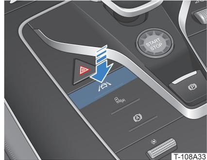
Drücken Sie zum Einschalten des LKS auf die Taste
