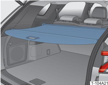
Ziehen Sie am Griff der Abdeckung und haken Sie die Begrenzungszapfen am Ende des Rollos in der entsprechenden Nut im Kofferraum ein.
