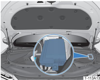
Sicherungskasten im vorderen Abteil
