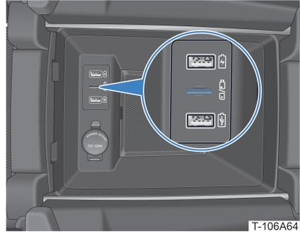
Stecken Sie die SD-Karte in den Kartenschlitz und drücken Sie sie bis zum Anschlag ein.
