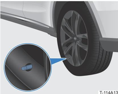
2. Schrauben Sie den Luftpumpen-Anschlussstecker auf das Reifenventil. Vom Ventil ist ein leichtes Luftaustrittsgeräusch zu vernehmen, das darauf hindeutet, dass Luft zirkuliert. Schrauben Sie weiter, bis dieses Geräusch nicht mehr zu hören ist.
