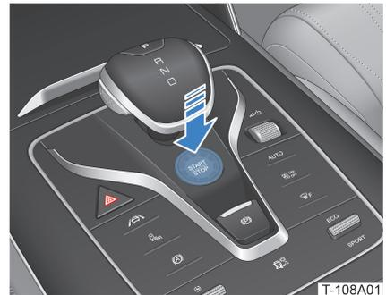
Zum Ein- bzw. Ausschalten des Fahrzeugs treten Sie mit im Fahrzeug befindlichen Fernbedienungsschlüssel das Bremspedal und drücken die START/STOP-Taste.
