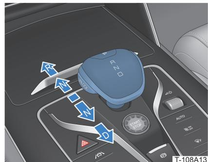
Treten Sie das Bremspedal und schalten Sie den Wählhebel in die gewünschte Richtung, nachdem das Fahrzeug vollständig angehalten hat. Bei Loslassen des Wählhebels kehrt er automatisch in die Mittelstellung zurück.
