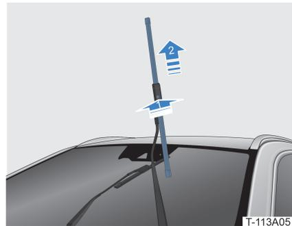
5. Gehen Sie genau umgekehrt vor, um das neue Wischerblatt in den Wischerarm einzuführen und zu verriegeln.
