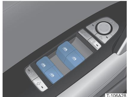
Die Fensterheberschalter sind bei eingeschaltetem Fahrzeug aktiviert.
