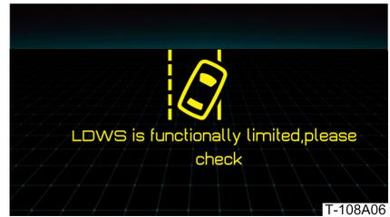
Wenn am Fahrzeug ein System- oder Betriebsfehler auftritt, werden am Kombiinstrument die betreffende Fehlermeldung und Handlungsanweisungen zum Beheben des Fehlers angezeigt:
