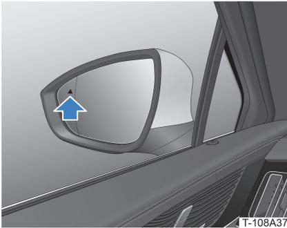
Wenn das Fahrzeug mit einer Geschwindigkeit über 30 km/h fährt und die Radarsensoren ein Fahrzeug im toten Winkel eines Außenspiegels erfassen, leuchtet die Warnleuchte am betreffenden Außenspiegel auf. Wenn gleichzeitig der Blinker auf derselben Seite gesetzt wird, blinkt die Warnleuchte am betreffenden Außenspiegel, um den Fahrer vor dem Spurwechsel zu warnen, da dieser Gefahren birgt.
