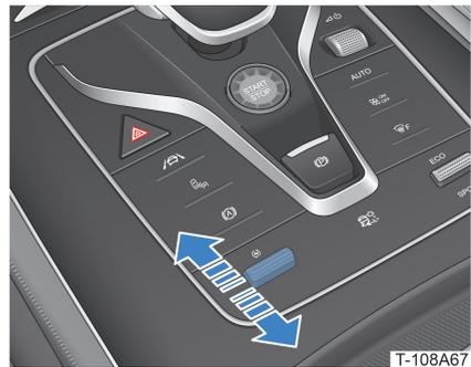
Schieben Sie beim Einschalten des Fahrzeugs den Hebel für Energieregenerierung vor oder zurück, um den Modus für verstärktes regeneratives Bremsen oder den Standardmodus für regeneratives Bremsen auszuwählen. Nach der Einstellung wird am Kombiinstrument der eingestellte Modus angezeigt.
