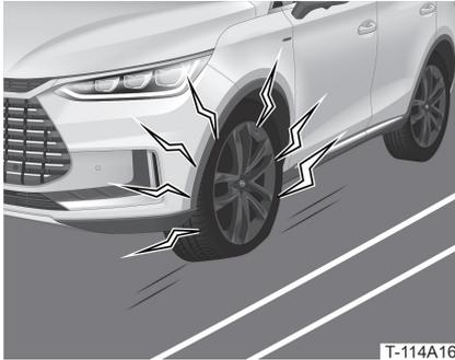
Platzt ein Reifen während der Fahrt oder verliert Luft, greifen Sie das Lenkrad fest mit beiden Händen und versuchen Sie gegenzulenken. Bremsen Sie langsam mit dem Bremspedal ab, damit Sie weiter geradeaus fahren können. Steuern Sie langsam eine sichere Stelle an und halten Sie an. Wechseln Sie den Reifen oder rufen Sie im Bedarfsfall den Pannendienst.
