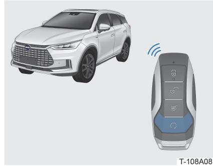
Bei im Signalerfassungsbereich befindlichem Fernbedienungsschlüssel drücken Sie zum Starten außerhalb des Fahrzeugs die Fernstart-Taste **START**.
