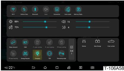
3. Legen Sie das Smartphone mit nach oben zeigendem Display auf die rutschfeste Gummiauflage der Ladefläche. Das Smartphone wird dann automatisch drahtlos geladen. Dies wird am Touchscreen der Mittelkonsole durch Leuchten des Ladesymbols angezeigt.
