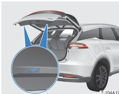
Beim Öffnen der Heckklappe schaltet die Kofferraumbeleuchtung automatisch ein.
