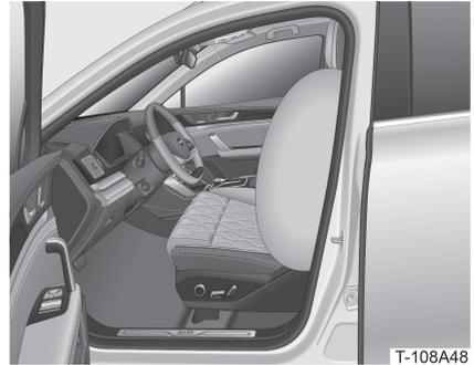
Die Seitenairbags an den Vordersitzen sind seitlich in die Rückenlehnen von Fahrer- und Beifahrersitz eingelassen und mit dem Schriftzug "AIRBAG" gekennzeichnet.
