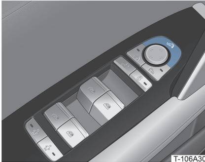
Drücken Sie zum An- und Ausklappen der Außenspiegel bei eingeschaltetem Fahrzeug auf die Taste
