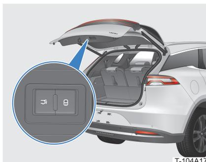
Bei offenem Kofferraum drücken Sie zum Schließen auf die Schließtaste .
