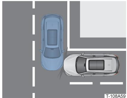
Das Fahrzeug erleidet einen Seitenaufprall durch ein anderes Fahrzeug, allerdings nicht an der Fahrgastzelle.
