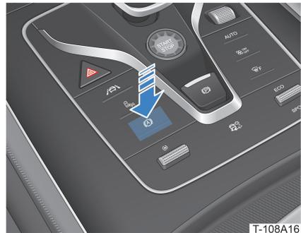
Soweit die obigen Bedingungen alle erfüllt sind, drücken Sie zum Einschalten der AVH die AVH-Taste. Die Kontrollleuchte der Taste leuchtet auf. Die AVH-Funktion ist dabei im Standby und die AVH-Kontrollleuchte im Kombiinstrument leuchtet (weiß).
