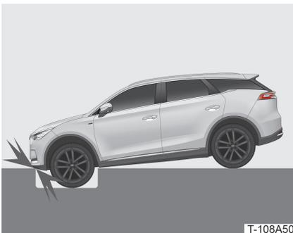
Die Fahrzeugfront setzt beim Durchfahren tiefer Schlaglöcher auf dem Boden auf.
