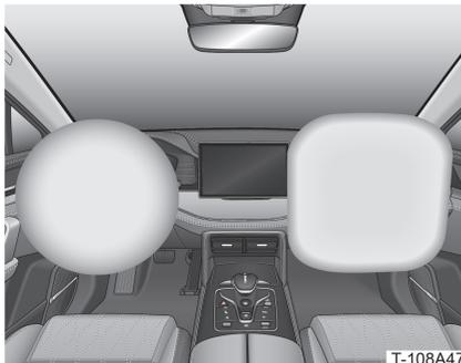
Die Frontairbags sind in das Lenkrad und in die Armaturentafel eingebaut und sind mit dem Schriftzug "AIRBAG" gekennzeichnet.
