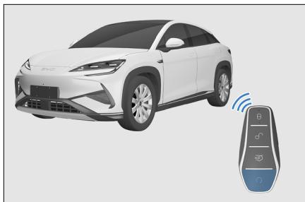
3. Um das Fahrzeug auszuschalten, halten Sie die Start-Stopp-Fernbedienungstaste am Smartkey 2 Sekunden lang gedrückt. Das Fahrzeug schaltet sich aus, und zur Bestätigung blinken die Blinker zweimal.
