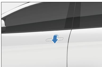
3. Ziehen Sie den Türgriff der Fahrertür so weit wie möglich zurück. Stecken Sie den mechanischen Schlüssel ein, drehen Sie ihn und ziehen Sie ihn wieder heraus. Ziehen Sie am Türgriff, um die Tür zu öffnen.
