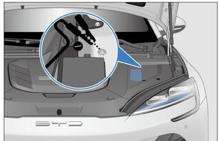
6. Schließen Sie das andere Ende des schwarzen Minuskabels (-) an einen geeigneten Befestigungspunkt (sauberes, unlackiertes, festes und geerdetes Metallteil) des zu rettenden Fahrzeugs an.
