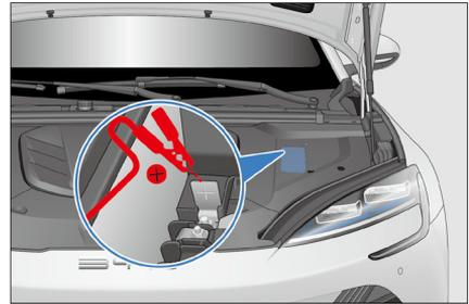
4. Verbinden Sie das andere Ende des roten Pluskabels (+) mit dem Pluspol (+) der geladenen Niederspannungs-Verteilerkasten des Rettungsfahrzeugs.
