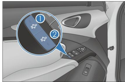
Drücken Sie zum Aktivieren des Kindersicherungs-Schlusses Kindersicherungstaste ① oder ②. Die entsprechende Anzeige leuchtet auf. Zu diesem Zeitpunkt können die Insassen die hintere Tür auf der entsprechenden Seite nicht öffnen. Drücken Sie zum Entriegeln der Tür erneut die Kindersicherungstaste für die jeweilige Seite oder benutzen Sie den äußeren Türgriff.
