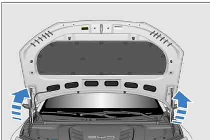
3. Zum Schließen der Haube: Ziehen Sie die Motorhaube nach unten und
