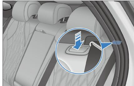
2. An der Abdeckung sitzt eine Notentriegelung. Öffnen Sie die Abdeckung im Auto, indem Sie am Notöffnungshebel auf der linken Seite ziehen (siehe Abbildung).
