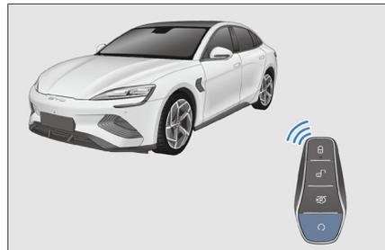
3. Halten Sie die Start/Stopp-Fernbedienungstaste auf dem Smartkey zwei Sekunden lang gedrückt. Das Fahrzeug stoppt und schaltet sich aus, und die Blinker leuchten zweimal auf.
