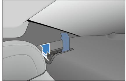
3. Befestigen Sie den Karabinerhaken an der Ankerhalterung und ziehen Sie die obere Leine fest, um sicherzustellen, dass der Gurt sicher verschlossen ist.
