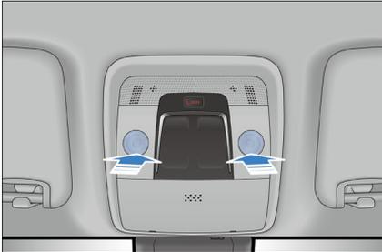
Ladeanschluss-Konfiguration II: Der vordere Innenraumlichtschalter
