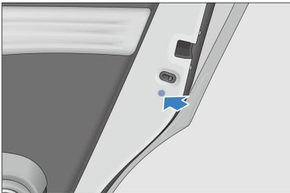
Das Etikett für die Verwendung des Ladeanschlusses ist an der Innenseite der Ladeanschlussklappe angebracht.
