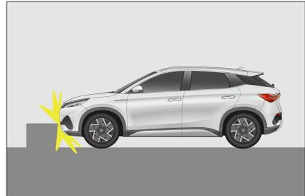
Wenn Sie einen steilen Abhang hinunterfahren, schlägt die Nase des Fahrzeugs auf dem Boden auf.
